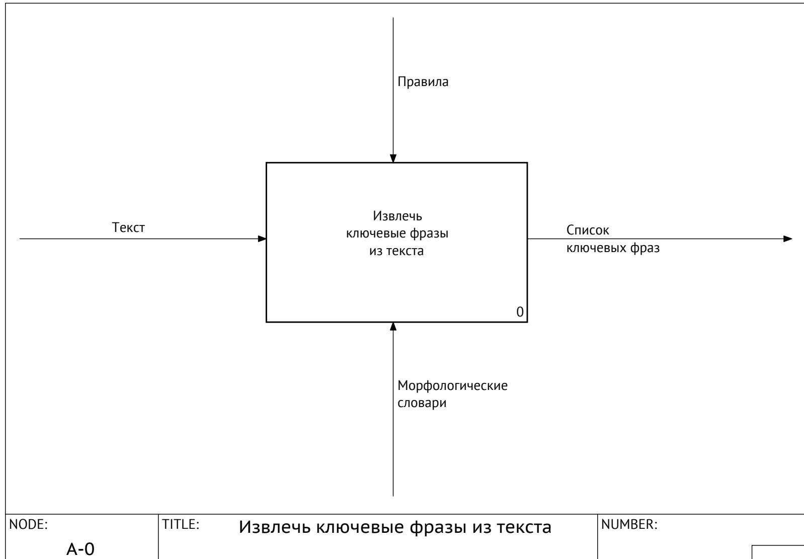
Рисунок А.1 — Функционально-структурная модель «Извлечь ключевые фразы из текста», узел А-0: контекстная диаграмма
